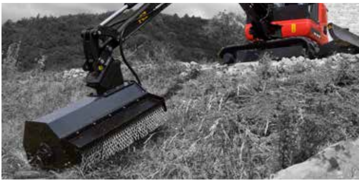
Hydraulikanlage für Mulcher mit zusätzlicher Pumpe (22 l/Min.)
