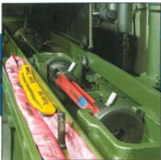
Ganzerreißprobe an fertigen Rundschlingen als Endkontrolle. 7-fache Sicherheit. Prüflast bis zu 80 Tonnen.
