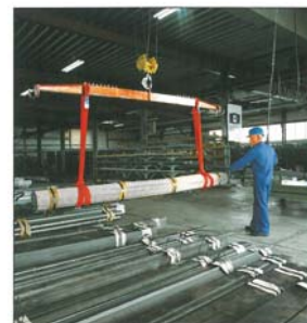
Schonender Transport dünner Stangen mit 2 Rundschlingen, einfach geschnürt
