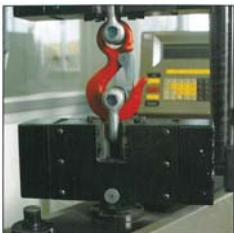
Festigkeitstest an Zubehörteilen aus hochfestem Sonderstahl Güteklasse 8. Bruchdehnung 25%, 4-fache Sicherheit.
